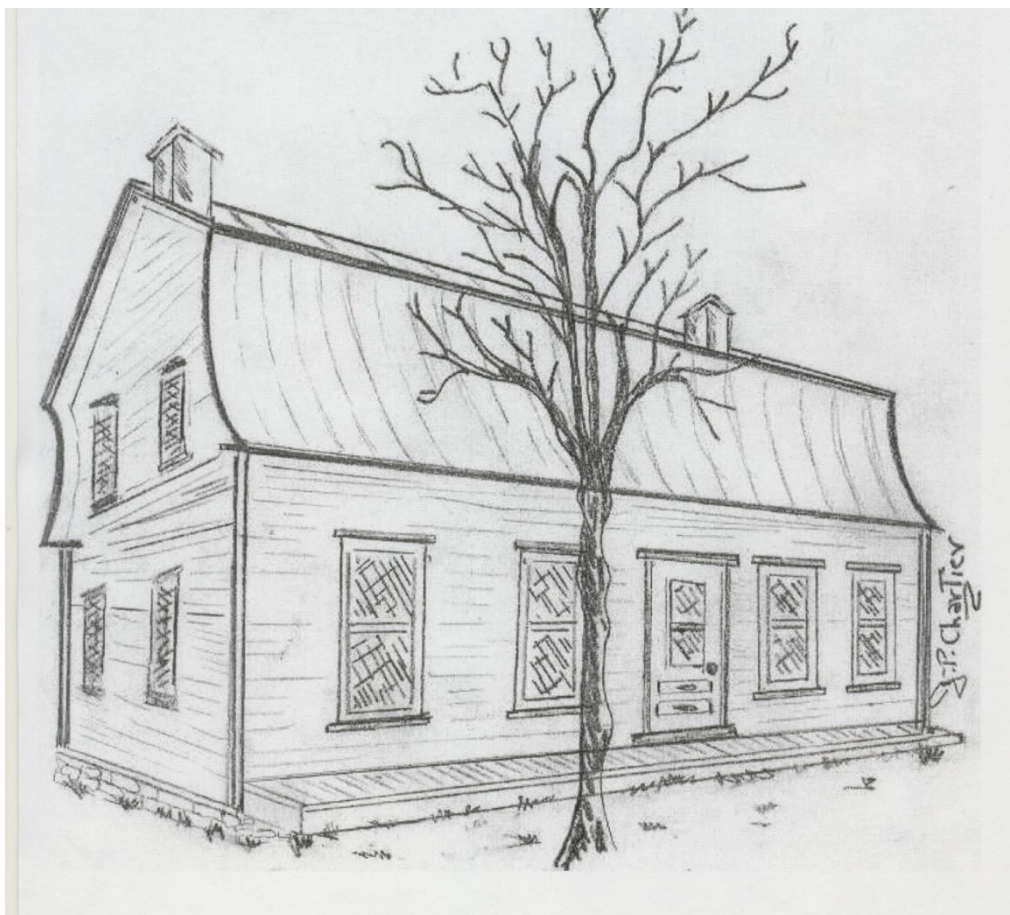
Type de maison à toit brisé, avec son terrasson à pente droite et ses deux brisis recourbés. Croquis de Jean-Pierre Chartier.
